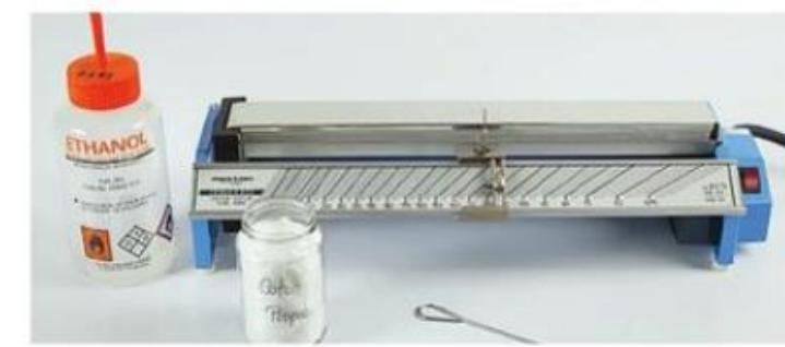
> Le banc Köfler permet de mesurer la température de fusion d'un solide.
